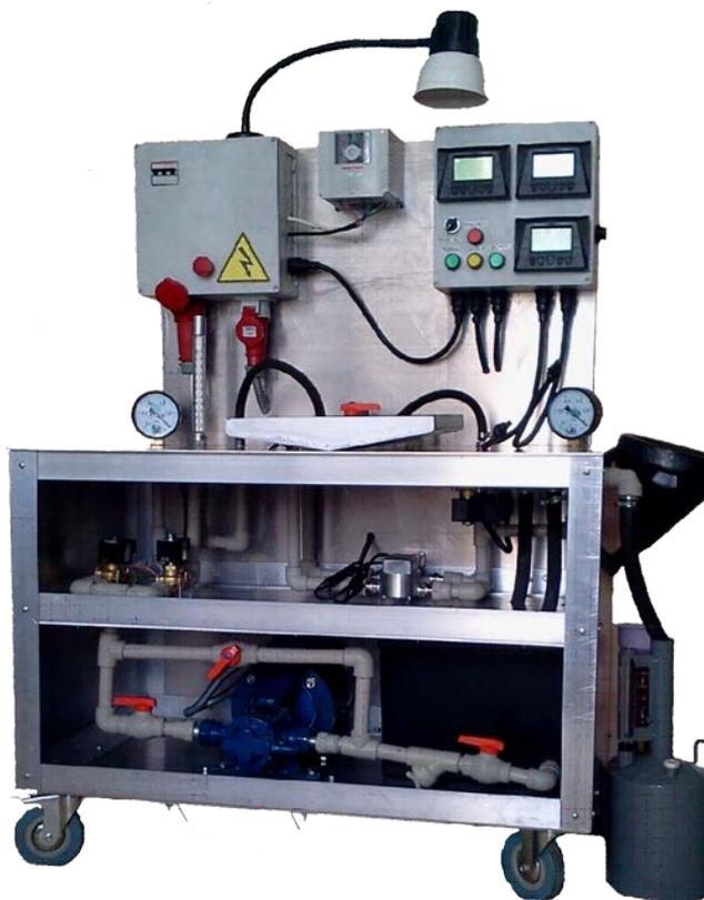
Рисунок 102 — Автоматизированная проливная установка APU 5
