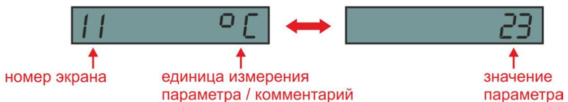
Рисунок 100 — Отображение информации на дисплее DFM i
